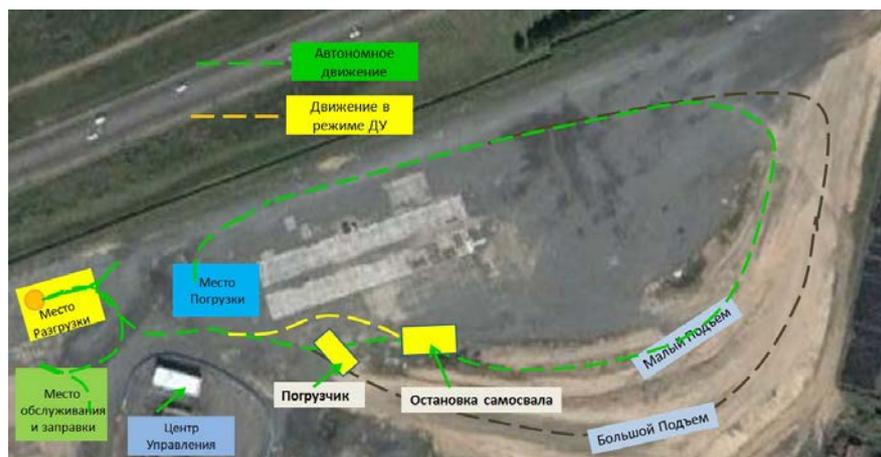
Рисунок 4.23 – Траектория автономного движения автосамосвала от места погрузки до места разгрузки с остановкой и объездом препятствия
