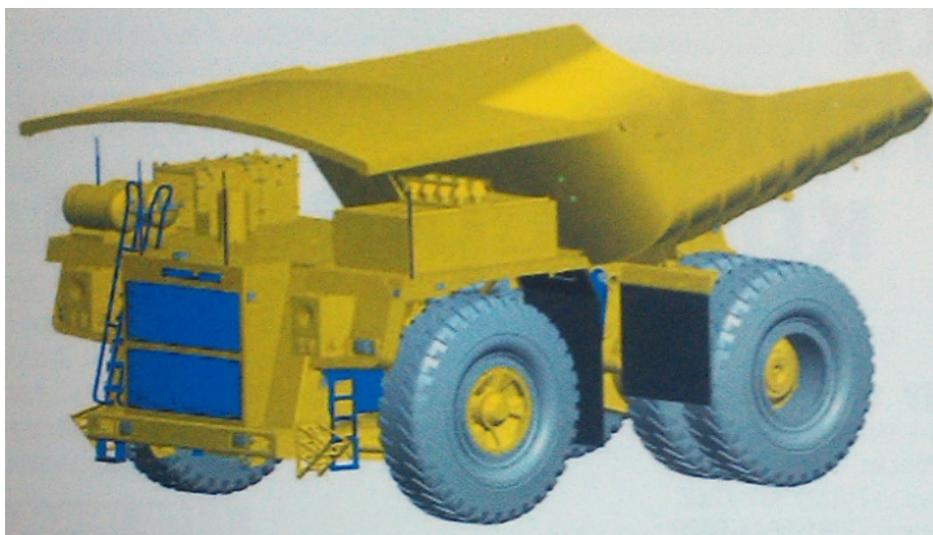
Рисунок 3.8 – Концепт-модель карьерного автосамосвала без кабины с увеличенным объемом кузова
