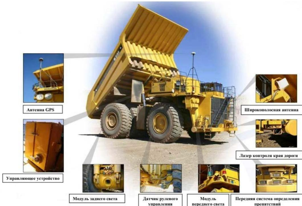
Рисунок 1.13 – Роботизированный автосамосвал Komatsu 930E-AT грузоподъемностью 290 т
