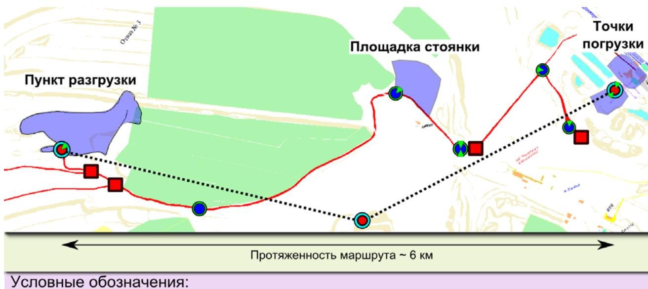
Рисунок 5.1 – Схема роботизированного участка «породный бункер-отвал» разреза «Черногорский»
