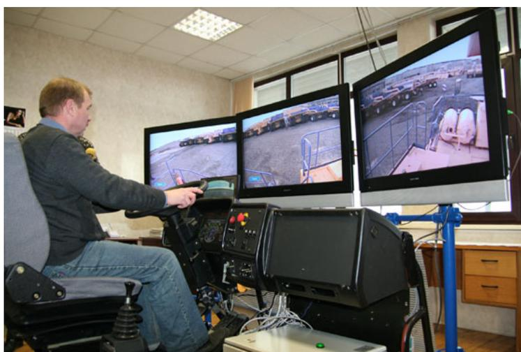
Рисунок 3.4 – Вид рабочего места оператора системы дистанционного управления автосамосвалом
