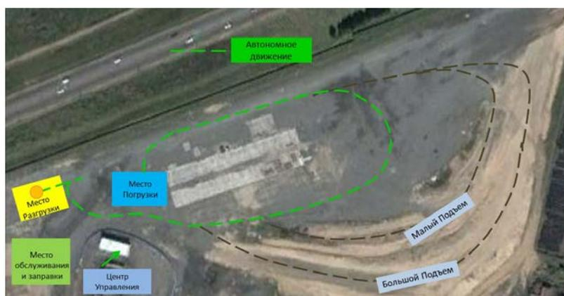
Рисунок 4.21 – Траектория автономного движения автосамосвала от места погрузки до места разгрузки
