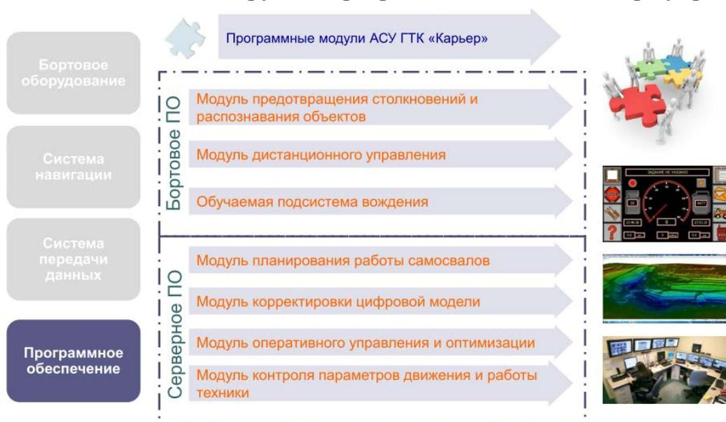
Рисунок 2.6 – Состав и функции программного обеспечения
