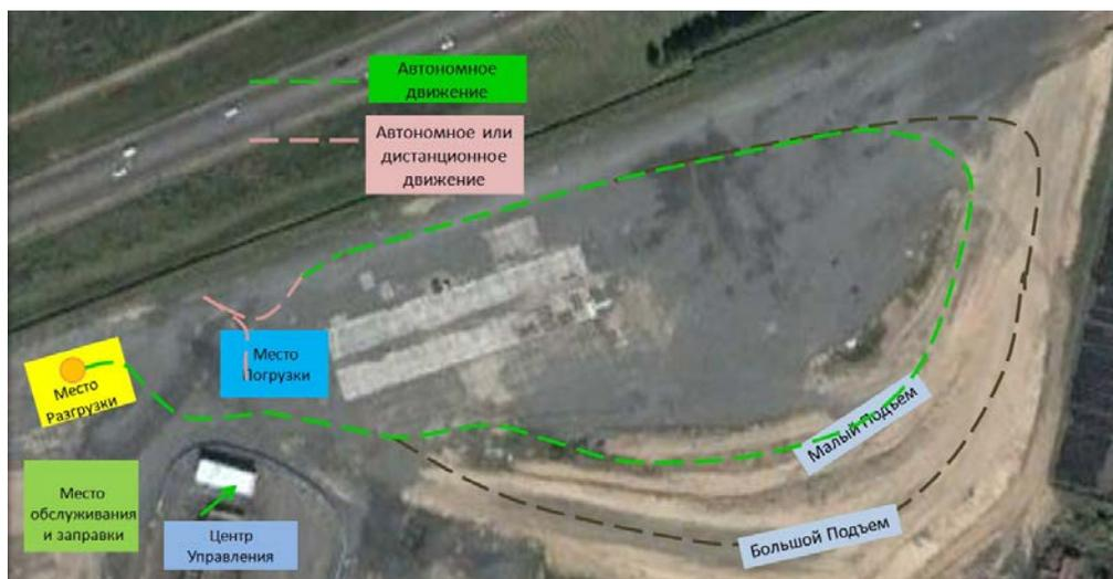
Рисунок 4.22 – Траектория автономного движения автосамосвала для отработки движения в различных режимах
