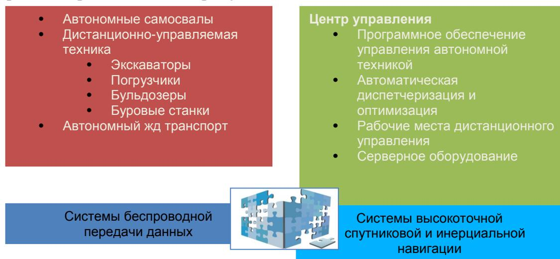
Рисунок 2.1 – Структура роботизированной системы грузоперевозок на горном предприятии
