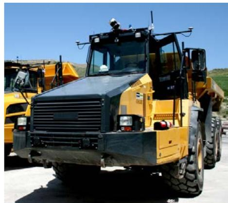
Рисунок 1.16 – Оборудование автономного управления и его размещение на борту шарнирно-сочлененного карьерного автосамосвала Komatsu NM-400
