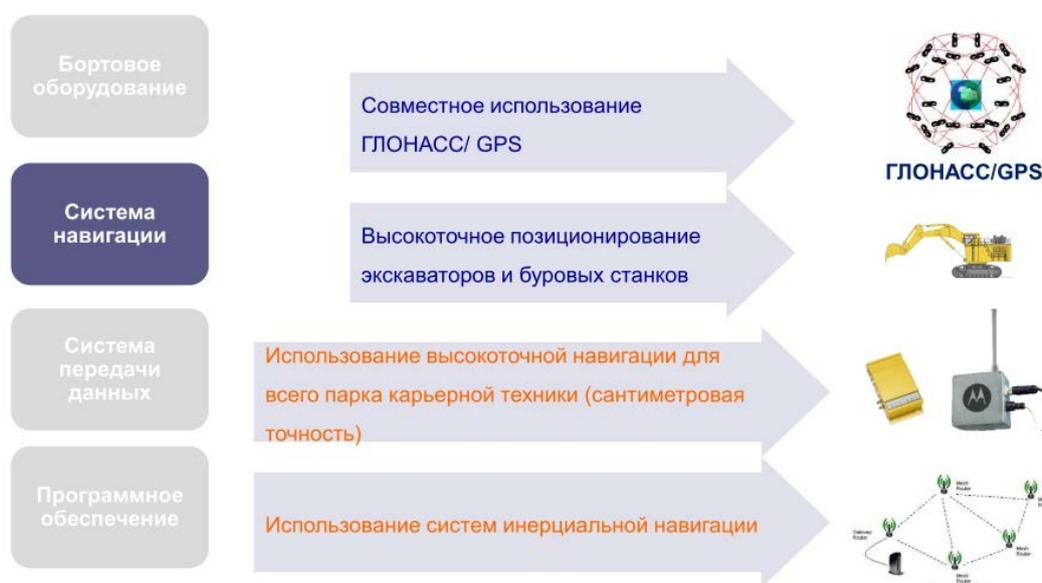
Рисунок 2.4 – Состав и функции подсистемы навигации
