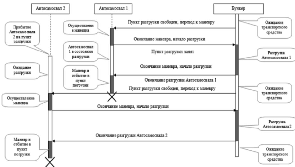
Рисунок 1.3 - Диаграмма последовательности взаимодействия карьерных автосамосвалов в процессе разгрузки на пункте разгрузки – бункере
