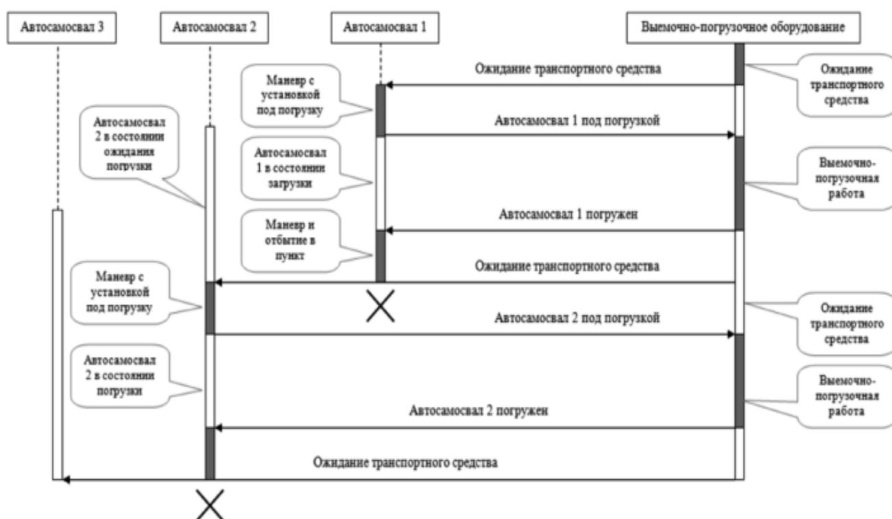
Рисунок 1.1 - Диаграмма последовательности взаимодействия карьерных автосамосвалов и выемочно-погрузочного оборудования
