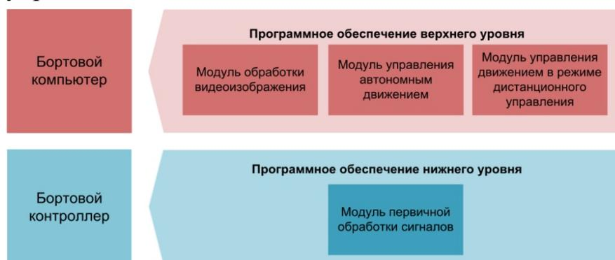
Рисунок 3.2 – Структура программного обеспечения роботизированного и дистанционно управляемого карьерного автосамосвала
