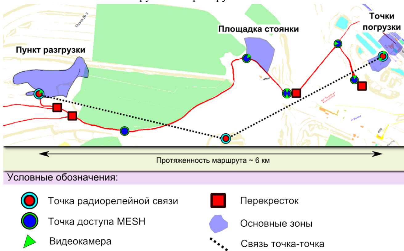
Рисунок 6 – Схема маршрута роботизированных автосамосвалов на участке «породный бункер-отвал» разреза «Черногорский»
