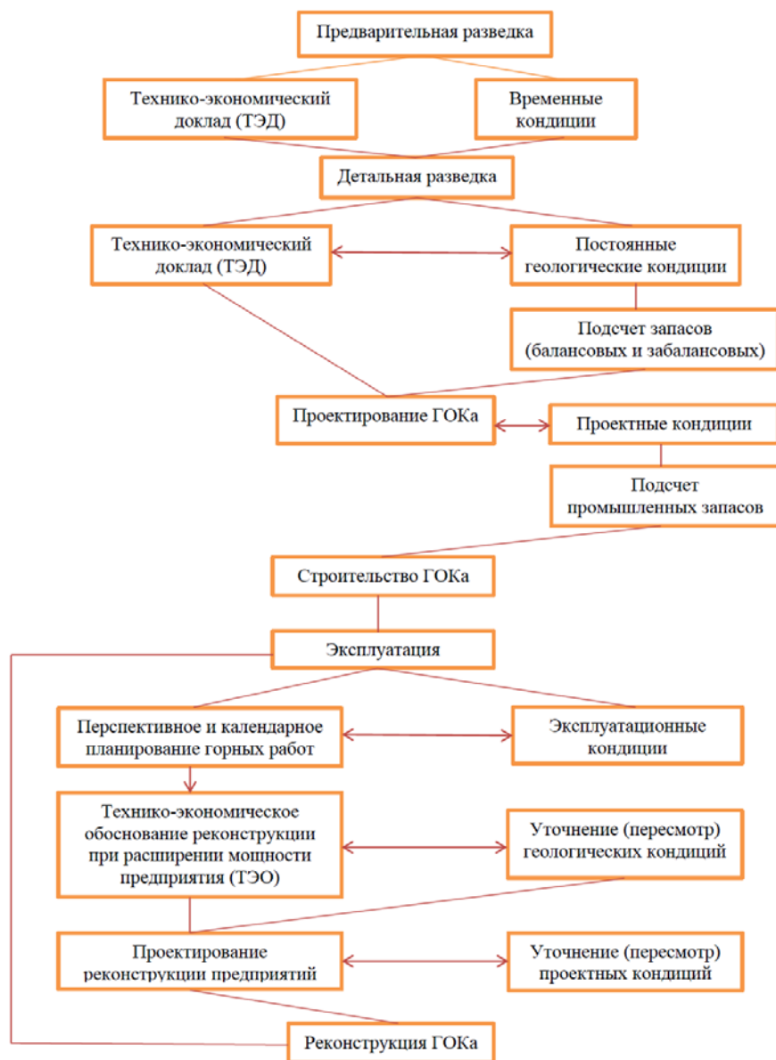
Рисунок 1.7 - Стадии расчета и взаимосвязь геологических, проектных и эксплуатационных кондиций.
