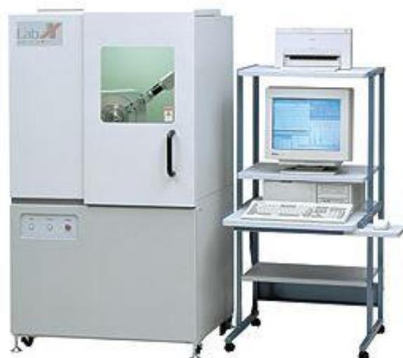
Рисунок 2.14 Рентгеновский дифрактометр Shimadzu XRD-6000.
