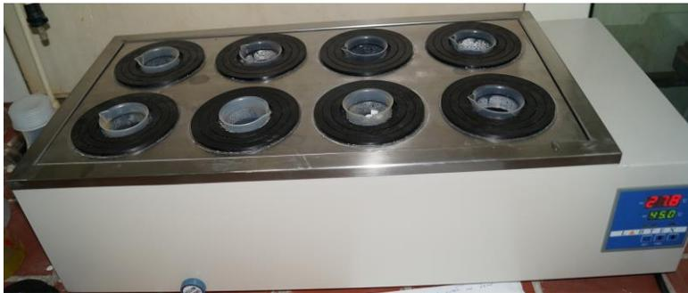
Рисунок 3.9 Водяная баня, проведение серии экспериментов попеременное увлажнение – высушивание с объектами ГПО и руды.
