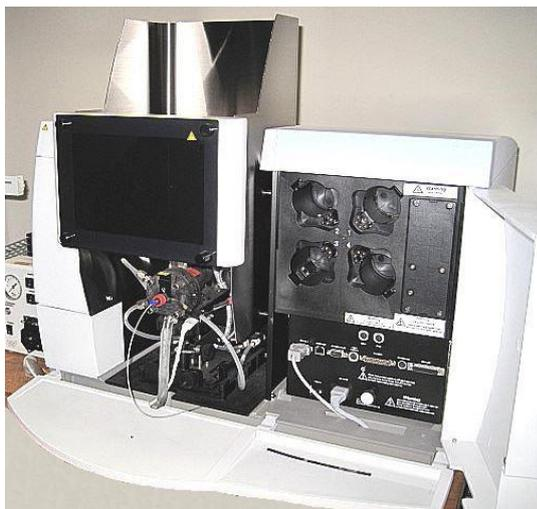
Рисунок 2.16 Атомно-абсорбционный спектрометр с пламенной атомизацией, AAAnalyst 400 PerkinElmer.
