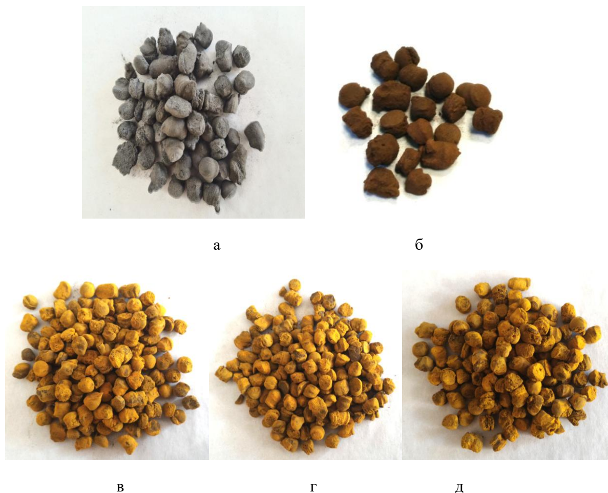
Рис. 7. Исходный материал (а), обожженный при температуре 650°C (б) и после фильтрации сульфатных растворов металлов через верхний (в), средний (г), нижний слой (д) геохимического барьера №1
