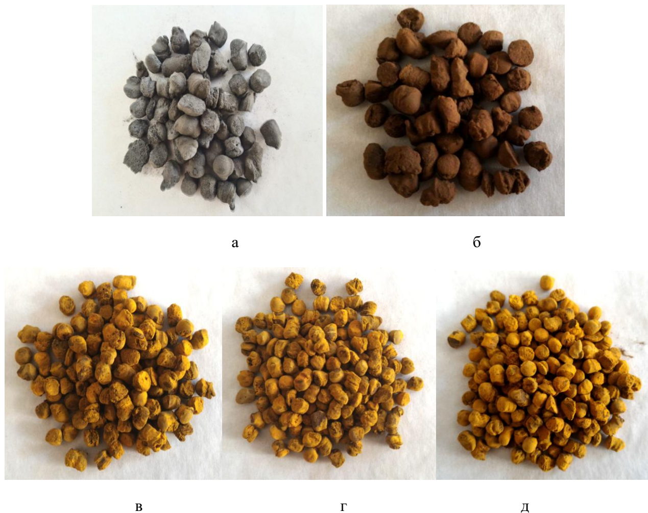
Рис. 8. Исходный материал (а), обожженный при температуре 700^{\circ}\text{C} (б) и после фильтрации сульфатных растворов металлов через верхний (в), средний (г), нижний слой (д) геохимического барьера №2
