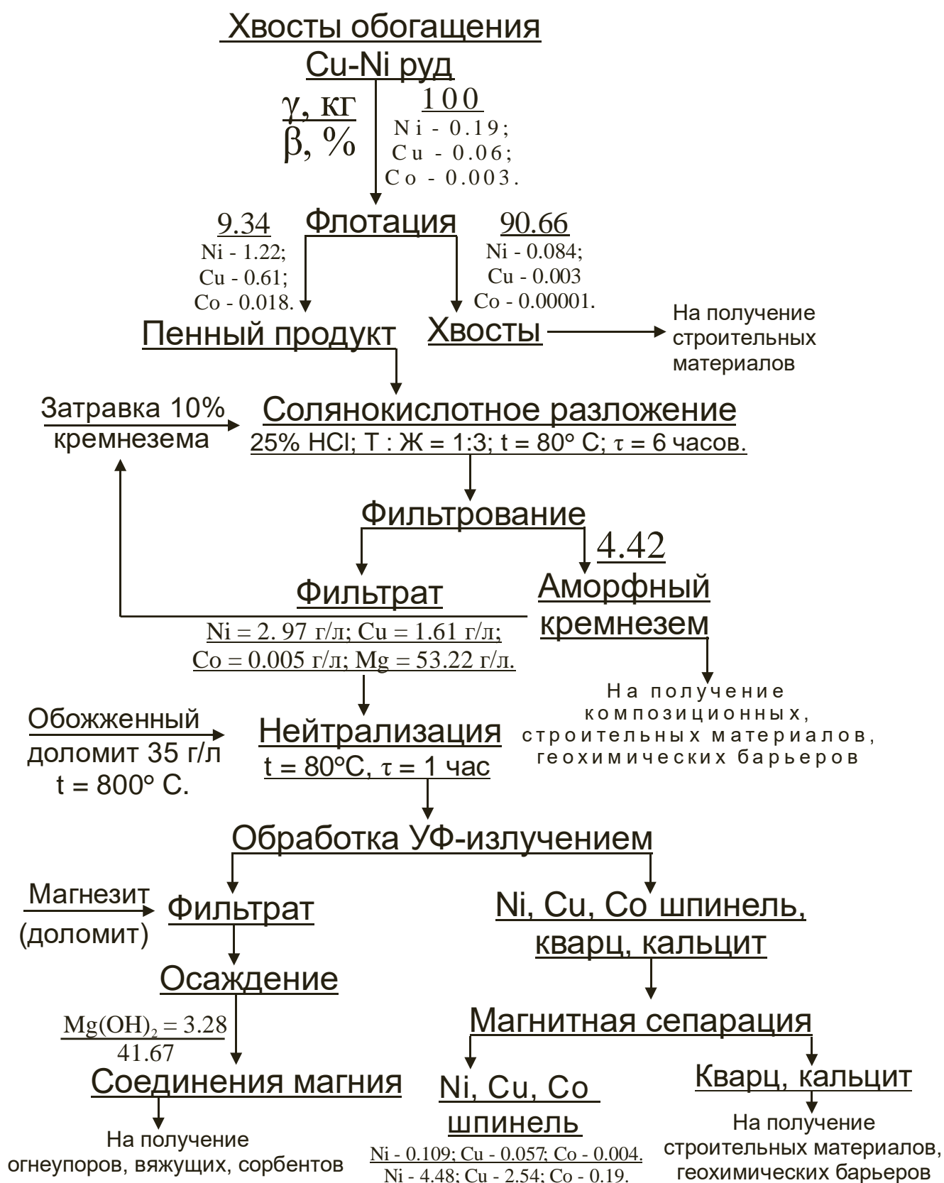
Рис. 48. Схема переработки хвостов обогащения медно-никелевых руд
