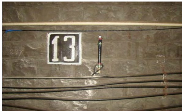
Рисунок 4.1.7 – Датчик ПЛДС на внутреннем контуре обделки (нагорная сторона).
