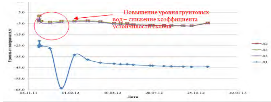
Рисунок 4.1.32 - График изменения уровней подземных вод по скважине № 2Г.
