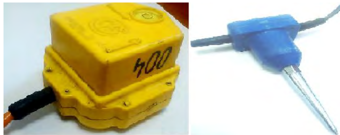
Рисунок 2.1. – Сейсмоприемники Houston, TX, USA (слева) и Geospase DX-20 (справа).
