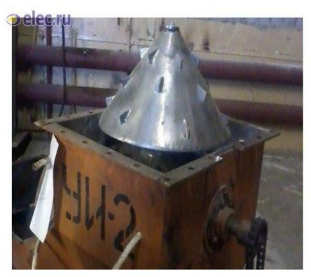
Рисунок 56 — Установка изготовления ВВ типа АСДТ (УИ-2) разработки Казахского политехнического института (правопреемник — НПП «ИНТЕРРИН») с измельчающим органом в виде конуса ( конус показан извлеченным из корпуса).
