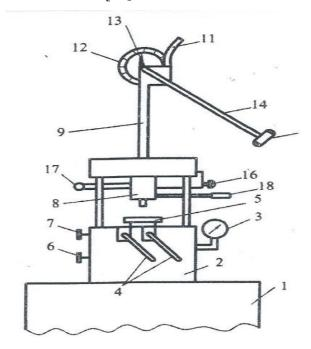
Рисунок 32 - Схема маятникового копра K-44-III.
