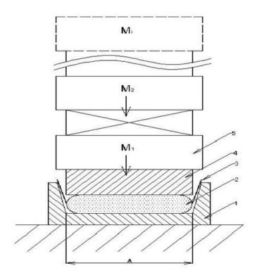
Рисунок 126 — схема сборки в процессе выдержи под нагрузкой в колонке В состав установки входят следующие элементы:
