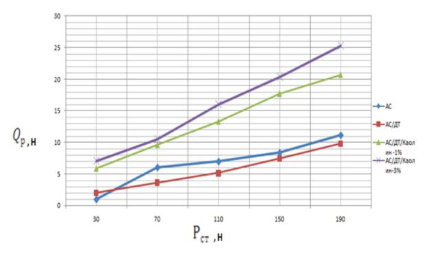
Рисунок 22 - Графики зависимости усилия разрушения брикетов от величины сжатия при выдержке для нитрата аммония с применением каолина.
