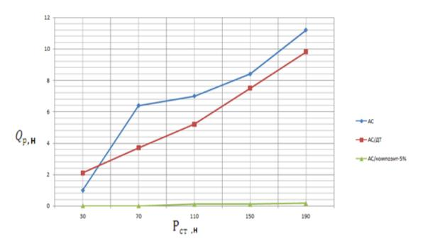
Рисунок 25 - Графики зависимости усилия разрушения брикетов от величины сжатия при выдержке для нитрата аммония с применением композитного материала.
