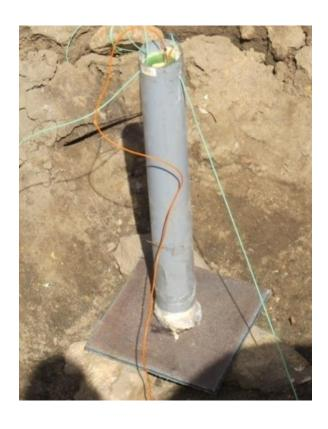
Рисунок 29 - Внешний вид заряда (фото) в оболочке из ПВХ тубы диаметром 100 мм (заряд, для уменьшения интенсивности ударной волны, установлен в воронке в грунте от предыдущего опыта)
