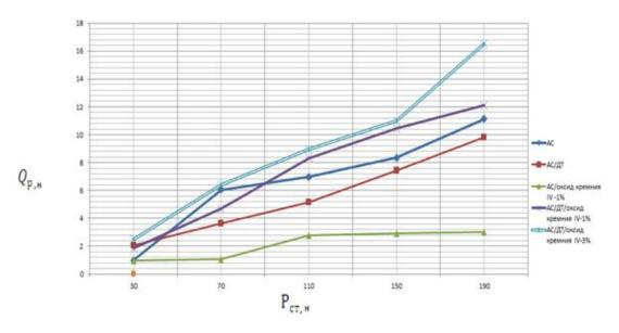
Рисунок 17 – Графики зависимости усилия разрушения брикетов от величины сжатия при выдержке для слеживаемости нитрата аммония с применением оксида кремния.
