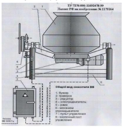
Рисунок 6 - Схема смесителя барабанного типа разработки НТФ. "Взрывтехнология" [Информационные материалы предприятия]
