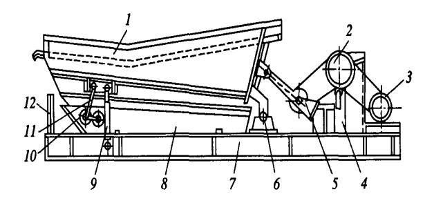
Рисунок 1 - установка растаривания качающаяся.
