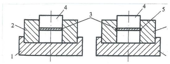
Рисунок 35 -Схема испытательных сборок (приборчиков) для определения чувствительности ВВ к удару на копре (К-44-Пили копер Каста). Справа показан приборчик с кольцевой проточкой в зоне расположения ВВ
