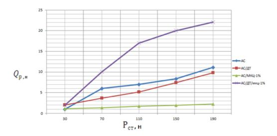
Рисунок 14 - Графики зависимости усилия разрушения брикетов от величины сжатия при выдержке для нитрата аммония с применением микрокристаллической целлюлозы (МКЦ).
