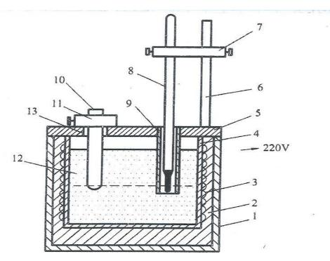
Рисунок 36 - Устройство прибора для определения температуры вспышки.
