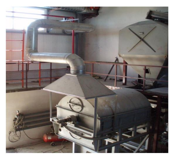
Рисунок 11a — барабанный аппарат нагрева AC с бункером питателем (на фото - справа вверху) и системой вентиляции с зонтом над зоной выгрузки
