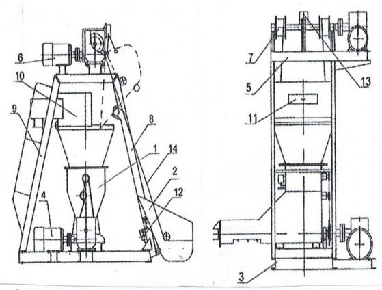
1 - смеситель, 2 - скип, 3 - основание, 4 - привод вращения шнеков, 5 - рама, 6 - привод подъема скипа, 7 - барабаны, 8 - направляющие (горка), 9 - лестница, 10 - вытяжка, 11 - фильтр зернистый, 12 - выключатели концевые, 13 - кронштейн, 14 - трос.
