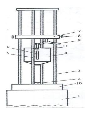
Рисунок 34 - Копер для определения чувствительности ВВ к удару.
