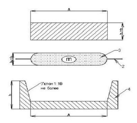
Рисунок 12a — Схема элементов сборки для оценки слеживаемости гигроскопичных материалов при сжатии "сдавливании".
