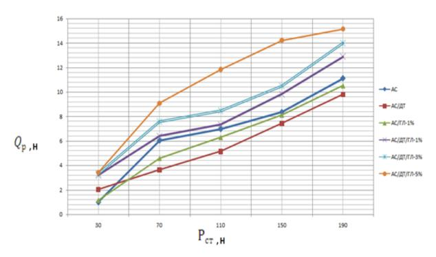
Рисунок 24 - Графики зависимости усилия разрушения брикетов от величины сжатия при выдержке для нитрата аммония с применением гидролизного лигнина (ГЛ).
