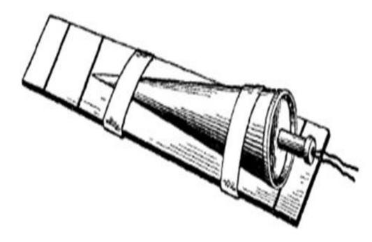
Рисунок 31 — Общий вид заряда для определения критического диаметра детонации (воспроизведена "классическая" схема из книги К.К. Андреева).
