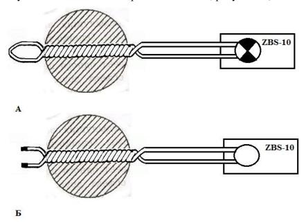
Рисунок 26 — схема датчика «ионизационного типа» и его состояния в различных режимах работы измерительной системы: А — проверка цепи на целостность (сигнальная лампа на приборе горит); Б — режим готов (лампа выключена).
