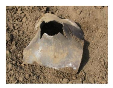
Рисунок 30 - Вид плиты-свидетеля со стороны, обратной расположению заряда, после опыта (сквозное пробитие плиты с выбросом "пятака" в грунт и разрывом кромок отверстия - детонация испытуемого заряда "полная"
