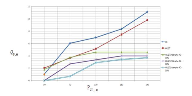
Рисунок 18 - Графики зависимости усилия разрушения брикетов от величины сжатия при выдержке для нитрата аммония с применением гранулированной аммиачной селитры по ГОСТ 2-2013.
