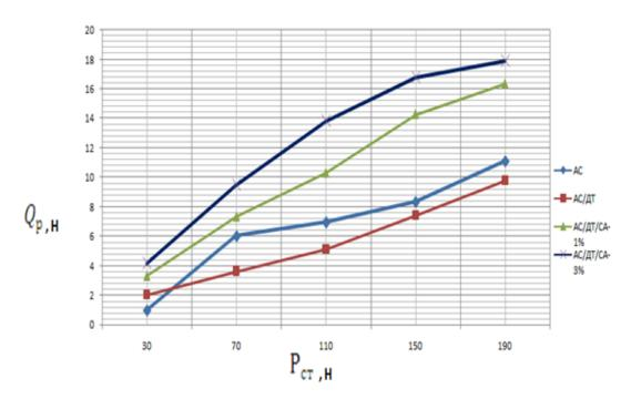
Рисунок 23 - Графики зависимости усилия разрушения брикетов от величины сжатия при выдержке для нитрата аммония с применением сульфата аммония
