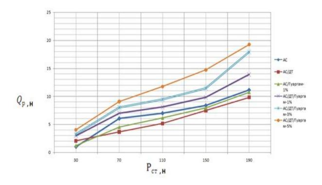
Рисунок 19 - Графики зависимости усилия разрушения брикетов от величины сжатия при выдержке для нитрата аммония с применением гуаргама.
