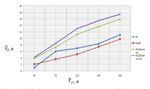
Рисунок 21 - Графики зависимости усилия разрушения брикетов от величины сжатия при выдержке для нитрата аммония с применением цеолита натрия.
