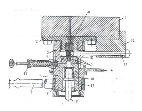
Рисунок 33 - Узел рабочей сборки прибора K-44-III в положении после удара.
