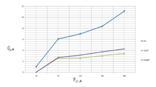
Рисунок 16а - Графики зависимости усилия разрушения брикетов от величины сжатия при выдержке для порошков аммиачной селитры и смесей АС с добавкой парафина и динитротолуола при нагревании системы выше температуры плавления.
