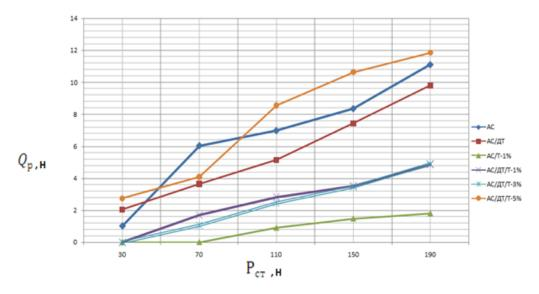
Рисунок15–Графики зависимости усилия разрушения брикетов от величины сжатия при выдержке для зависимости слеживаемости нитрата аммония с применением технического тамаринда.
