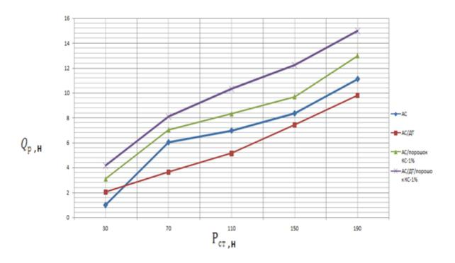
Рисунок 20 - Графики зависимости усилия разрушения брикетов от величины сжатия при выдержке для нитрата аммония с порошкообразной кальциевой селитры.
