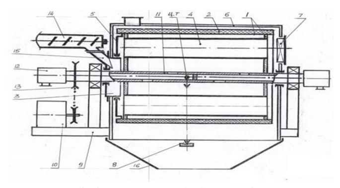
Рисунок 11 - схема барабанного аппарата нагрева (БАН) с шестью рабочими полостями (поз.4), обогреваемыми водой, которая подается в полый вал (11) через муфты ввода потока (12).
