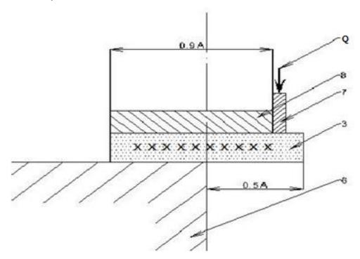
Рисунок 12в – Схема установки по определению слеживаемости в режиме разлома.
