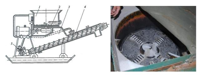
Рисунок 4- Измельчитель-смеситель игданита (ИСИ-II) разработки производственного объединения «Северовостокзолото» (г. Магадан) с рыхлительно-сепарирующим органом в виде горизонтального вращающегося диска (тарели) с отверстиями (на фото справа)
