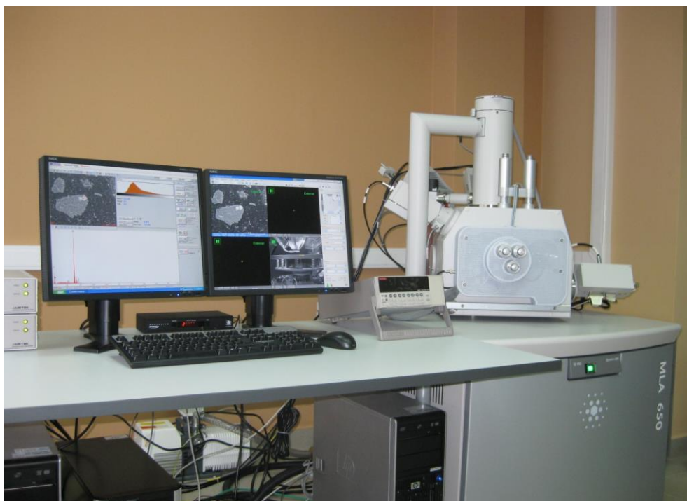
Рисунок 2.14 – Автоматизированный минералогический комплекс MLA System
