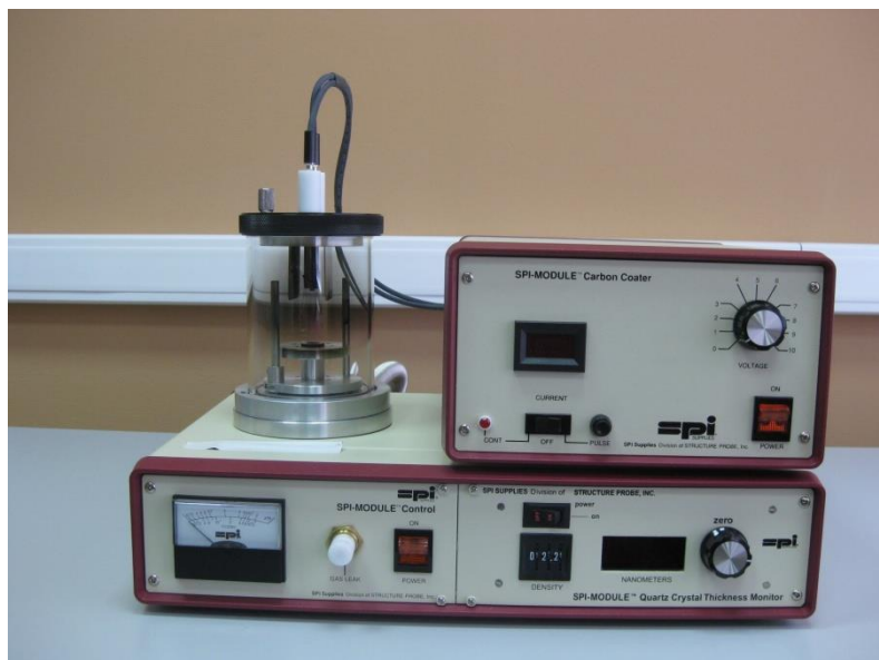
Рисунок 2.13 - Система для напыления углеродного слоя SPI-Module
