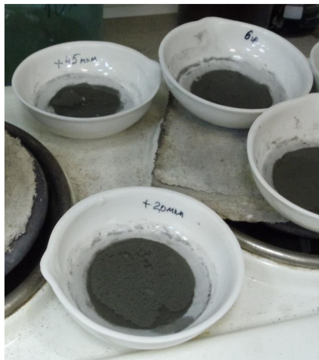
Рисунок 2.7 – а) сбор в колбу класса минус 10 + 0 мкм; б) чаши для выпаривания с продуктами рассева
