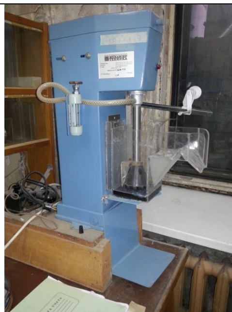
Рисунок 2.4 – Машина флотационная лабораторная 240ФЛ (камера 3 л)
