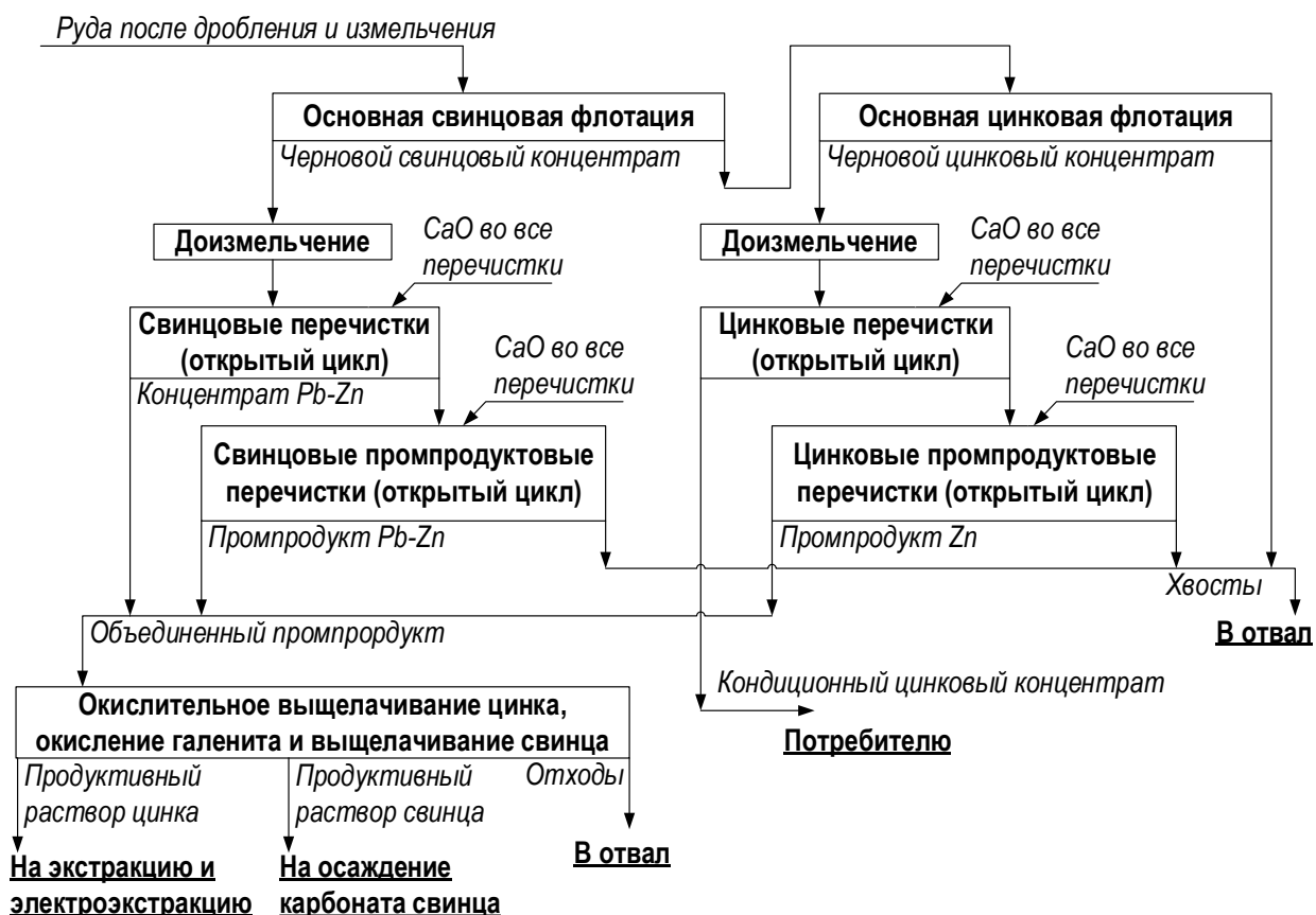
Рисунок 5.6 – Предлагаемая комбинированная технология переработки упорной свинцово-цинковой руды с высоким содержанием флотактивного пирита
