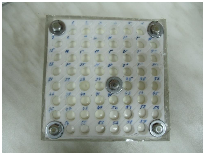
Рисунок 2.8 - Форма для заливки образцов
