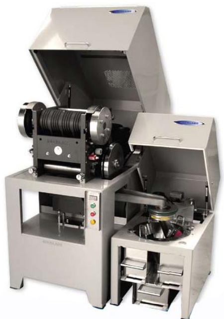
Рисунок 2.1 - Щековая дробилка «Boyd» с непрерывным сократителем Rocklabs
