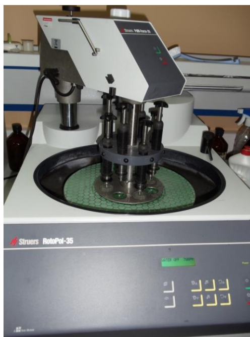
Рисунок 2.11 - Шлифовально-полировальный станок RotoPol-35
