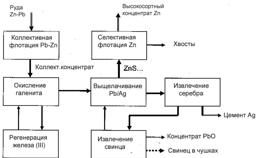
Рисунок 1.2 – Принципиальная последовательность операций процесса PRIMALEAD
