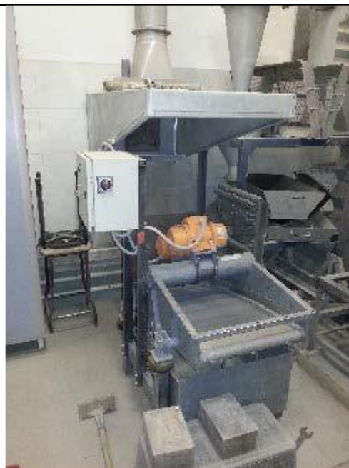
Рисунок 2.2 – Инерционный самобалансный вибрационный грохот ГИС-051
