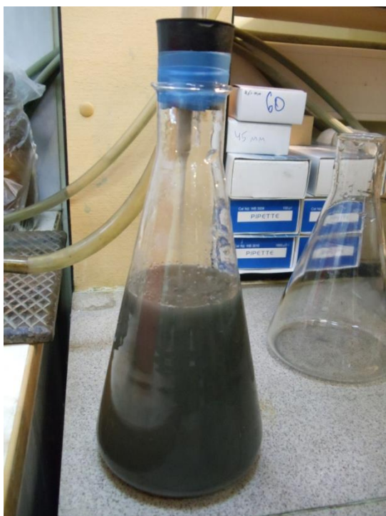
Рисунок 2.7 – а) сбор в колбу класса минус 10 + 0 мкм; б) чаши для выпаривания с продуктами рассева
