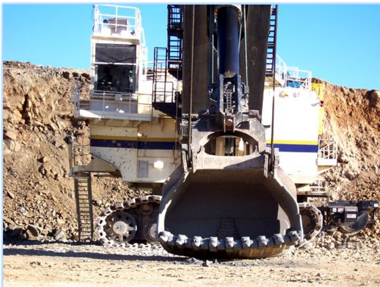
Рисунок 1.1 – Форма ковша экскаватора Вискус 495HD .
