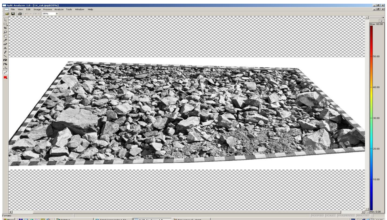
Рисунок 3.5 – Типовая фотопланограмма гранулометрического состава раздробленной породы, которая характеризуются величиной средневзвешенного размера кусков D_{св}= 0,192 м.
