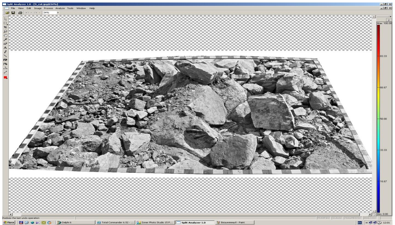
Рисунок 3.8 – Типовая фотопланограмма гранулометрического состава раздробленной породы, которая характеризуется величиной средневзвешенного размера кусков D_{св} = 0,700 м.
