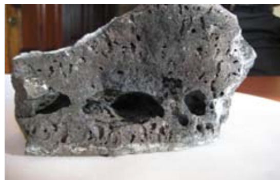
Рисунок 8 - Шлаковая глыба в разрезе с густым известковым налетом.
