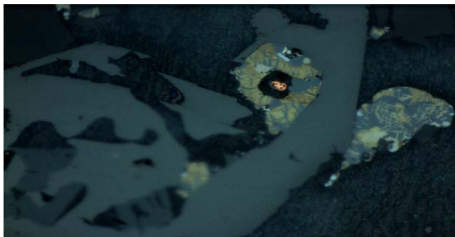
Рисунок 6 - Сложный сульфидный сросток - «пиритовая медьсодержащая глобула»: в центре пиритового зерна находится королек металлической меди размером 3 мкм. Пиритовое зерно окаймлено магнетитовой «лентой»
