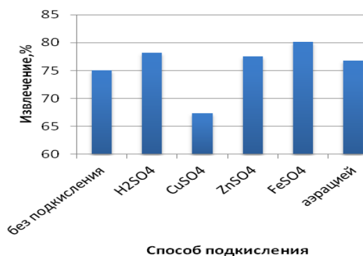
Рисунок 20 - Влияние способа подкисления оборотной воды на извлечение меди в концентрат
