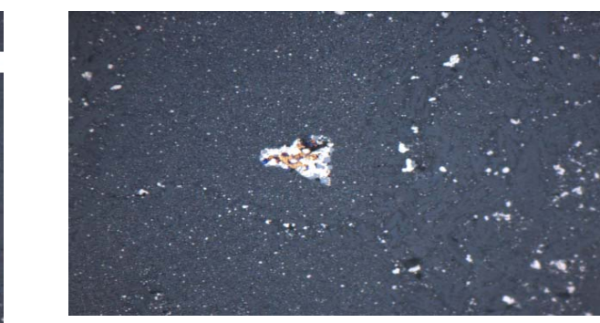
Рисунок 5 - Агрегаты сульфидных твердых растворов в отвальном шлаке: а) зерно пирита правильной формы с примесью меди (борнит) окаймлено магнетитовой ипителью; б) сплав (борнито-пиритовое зерно). По шлаковому полю зерна фаялита. Отраженный свет, николи параллельны
